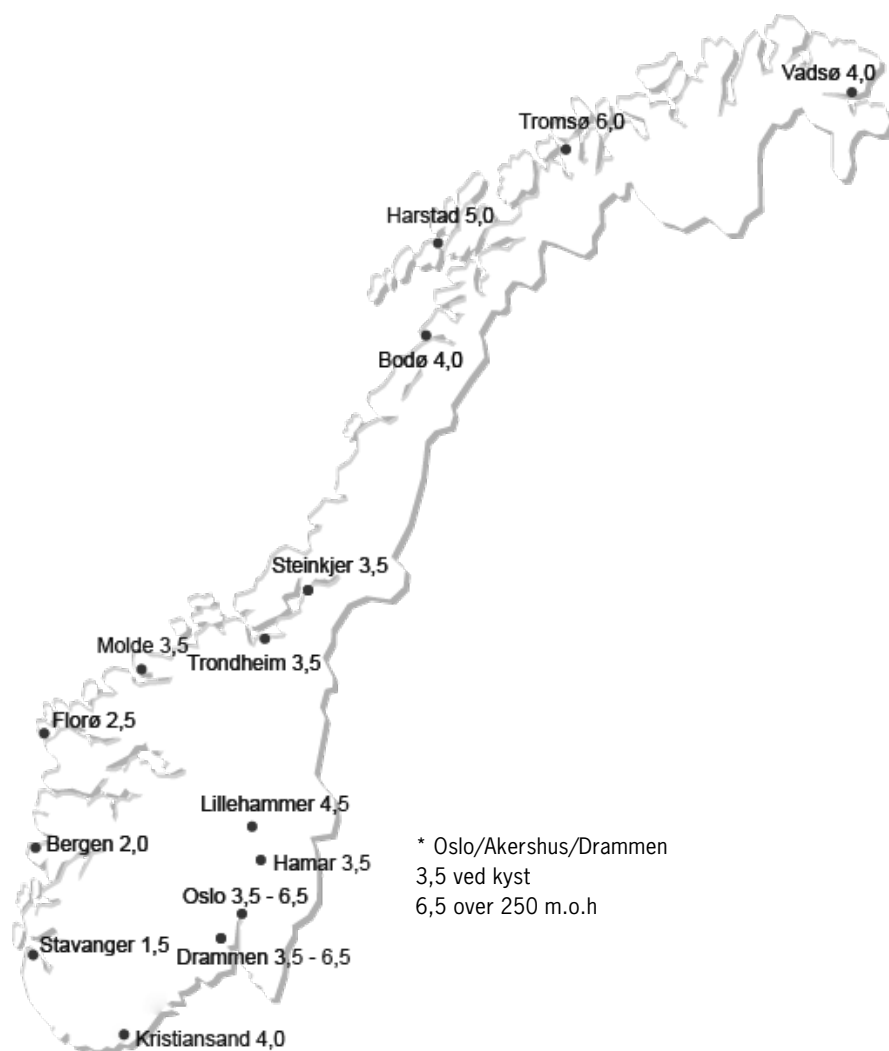
TwinLite. Terrassetak og SunGlaze Tak: Figur. A: Max. mm. avstand (c/c) mellom lektene.
